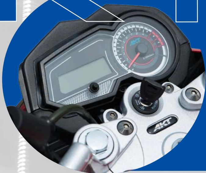
*Tacómetro (rpm) análogo y velocímetro digital en (km/h) con diferentes funciones como son el odómetro (cuenta kilómetros), un trip (cuenta kilómetros parciales), indicador de marcha, indicador de combustible y sus testigos de luces.*
