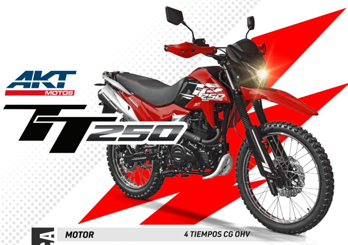
CILINDRAJE (CC) 229,5 CC **POTENCIA (HP)** 16.3 HP @ 7000 RPM 16.5 NM @ 5500 RPM **TORQUE (NM)** RELACIÓN DE COMPRESIÓN 8.7:1 **ALIMENTACIÓN CARBURADOR CAJA 5 VELOCIDADES ARRANQUE** ELÉCTRICO Y PEDAL FRENO DELANTERO **DISCO LOBULADO** FRENO TRASERO **DISCO LOBULADO** SUSPENSIÓN DELANTERA TELESCÓPICA HIDRÁULICA SUSPENSIÓN TRASERA **MONOSHOCK REGULABLE** RUEDA DELANTERA 2.75 - 21 RUEDA TRASERA 4.10 - 18 **TIPO DE LLANTA NEUMÁTICO** PESO SECO (KG) 131 KG **CAPACIDAD TANQUE** 11 LITROS
