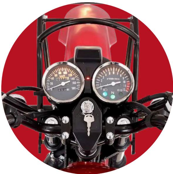
**Tablero mixto**, digital para la indicación de marchas e indicación del nivel del combustible. Análogo para las funciones de velocímetro (km/h), odómetro (km), tacómetro (rpm). Además, testigo de luces y neutra.
