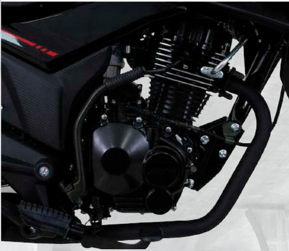
*La 150 R4 viene provista de un motor mono cilíndrico de 149.5 cc, entrega una potencia máxima de 11,4 Hp a 8.500 rpm y un torque máximo de 10 Nm a 7.500 rpm.*
